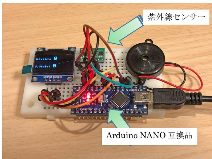
特性の異なった2種類の紫外線の差分をとって可視光を除外して近UV領域の紫外線量を測定するのがトレンドのようで、秋月電子から「S-5420 使用 紫外線センサモジュールキット」として入手可能です。これを用いて出力を Arduino UNO で AD 変換して小型グラフィックディスプレイに表示するキットです。ブレッドボードに配線した状態で、USB ケーブルから 5V を給電することで動作します。
