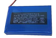
日立マクセル製 ICP545478AHRx3 使用 160g 11.4V(13.5Vmax) 3200mAh 80x54x15mm 事業届 H30.11.1 PSE 略称表示承認 H30.12.19 保護 (過電圧,低電圧,過電流,短絡,温度ヒューズ)
