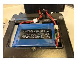
バッテリーは充電用コネクタを経由して FT-817/818 に接続します。(手順詳細は裏面に記載)
