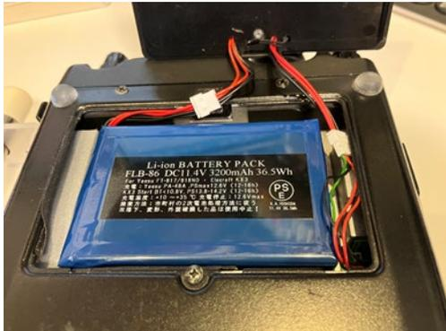
③ バッテリーケースから出ているケーブル (オス) を極性 (赤黒) に注意して FT-817/818 から出ているケーブル (メス) に接続します。
