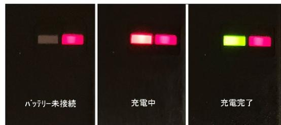
※もし、写真中のように LED が点灯して充電が開始されない場合は、AC プラグを抜いて再度接続してみてください。それでも動作しない場合は、Shop6502 までご連絡ください。
