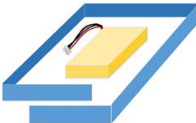
①テープの巻き始めと巻き終わりは、寸法が増加しても影響のないように、図に示した位置を選んでください。電池の厚みは15mmなので、25mm幅のテープを使用します。
