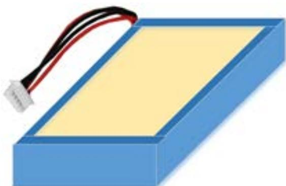
②テープの端を折り曲げ、電池のエッジを確実に保護します。ケーブルの引き出し部分は、テープに切り込みを入れて処理します。
