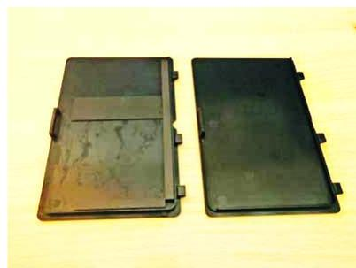
万が一、バッテリーの絶縁被覆に傷がついているようであれば、寺岡製作所ポリエステルフィルム粘着テープ No.631S #25 青(25mm 幅、0.05mm 厚)で補修してください。市販のビニールテープでは厚すぎます。
