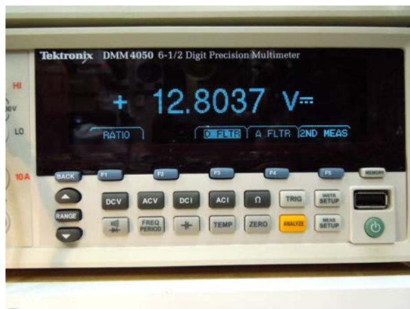
⑪ VR を調整し入力 15V 時、出力 12.8V
