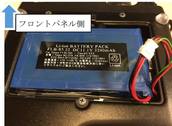
② 写真のようにバッテリー配置した後、コネクタを接続し、コネクタ部を外装の下に格納します。
